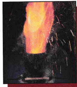
Fig. 9. Reacția exotermă dintre \text{Al} și \text{Fe}_2\text{O}_3 , cunoscută sub denumirea de „reacție termită”, decurge violent după momentul declanșării.
